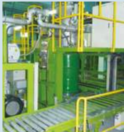
高性能で信頼性が高い「漏れ検査機」ヘリウムリークテスターを導入
